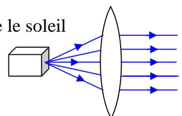
Une lentille à bords minces transforme un faisceau de rayons parallèles en un faisceau convergent après la lentille. Cette lentille est convergente.
