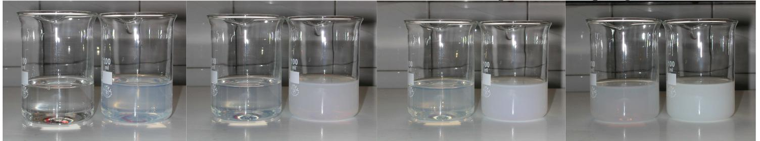
(à placer sur rétroprojecteur, dans le 1<sup>er</sup> bécher, 20 mL de solution de  $\text{Na}_2\text{S}_2\text{O}_3$  à  $0,1 \text{ mol.L}^{-1}$ , dans le 2<sup>ème</sup> bécher, 20 mL de solution de  $\text{Na}_2\text{S}_2\text{O}_3$  à  $0,05 \text{ mol.L}^{-1}$  .
